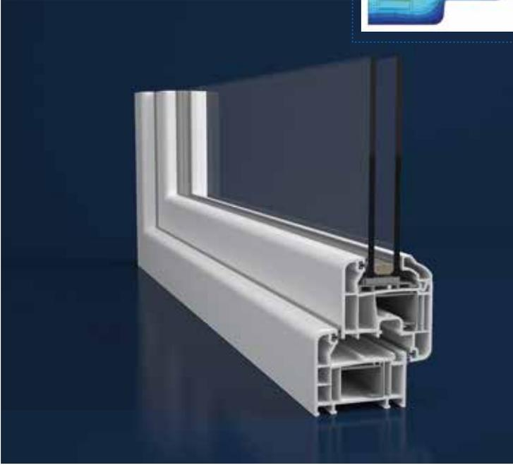
TS 5358-EN 12608'e uygunluk sağlamaktadır. Alt-üst kalınlıkları 2,5 mm, yan duvar et kalınlıkları ise 2 mm olup B sınıfı profil sistemidir. L41 kasa, T40 ortakayıt, Z-58 kanat, Z-75 kapı kanat, dışa açılan 75 mm kapı kanat ve Zirve Kasa, sistemi oluşturan ana profillerdir. Cam çataları ve diğer donanımları bütün Zendow Sistemi ile birebir uyumludur.
